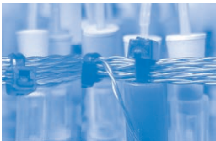
Abb. 5: Versuchskammern zur direkten Exposition von Pinealorganen durch schwache Magnetfelder. In jede Kammer werden Pinealorgane erwachsener Dsungarischer Hamster eingesetzt und mit Puffer überspült (perifundiert). Im Eluat wird anschließend Melatonin bestimmt. Zur Produktion von Melatonin ist es nötig, die Organe pharmakologisch zu stimulieren. Aus [100].
